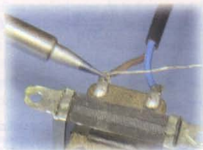
Figura 7.39. Conectando el cable de potencia
